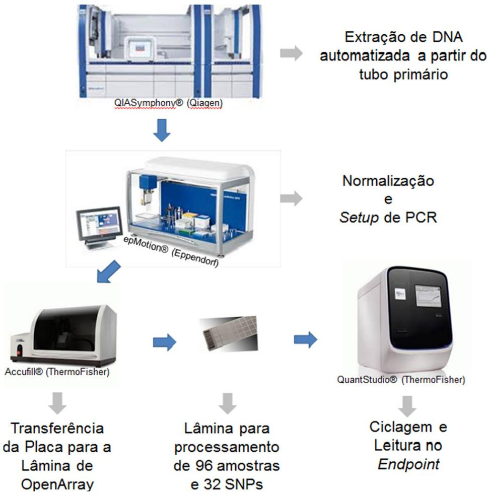
Figura 1. Descrição de todas as etapas de genotipagem de antígenos eritrocitários e plaquetários de doadores de sangue por técnica de microarranjos líquidos (OpenArray®). Todos os procedimentos foram realizados de forma automatizada e tiveram os resultados interfaceados para software especificamente elaborado para o projeto.
